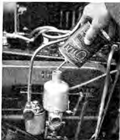
FIG. 28. FREEING STUCK PISTON
